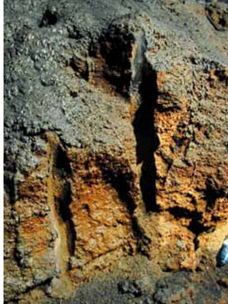
Fori raffreddati pronti per l'attività di caricamento (a destra); salamandra e sua sezione sul fronte di sparo (a sinistra)
